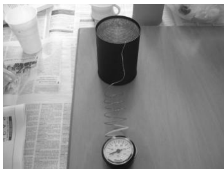
Τοποθέτηση θερμοστοιχείου στο δοχείο
