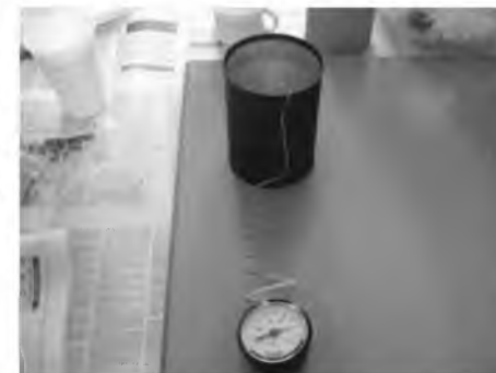
Τοποθέτηση θερμοστοιχείου στο δοχείο
