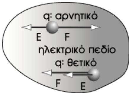
σχήμα 3. Κατευθύνσεις των E και F για θετικό και αρνητικό δοκιμαστικό
