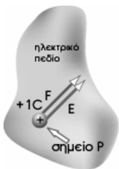
σχήμα 4. σχέση έντασης και δύναμης στο δοκιμαστικό φορτίο +1C φορτίο
