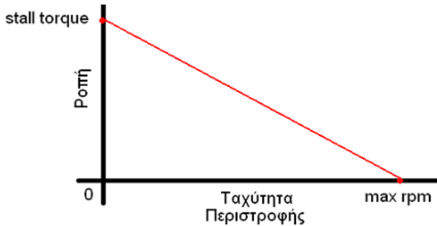
Σχήμα 1.2 : Σχέση ροπής και ταχύτητας περιστροφής ενός DC κινητήρα
