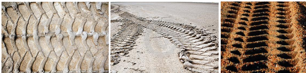
Σχήμα 14. Ίχνη τροχών κατά την κύλισή τους σε μαλακό έδαφος.
