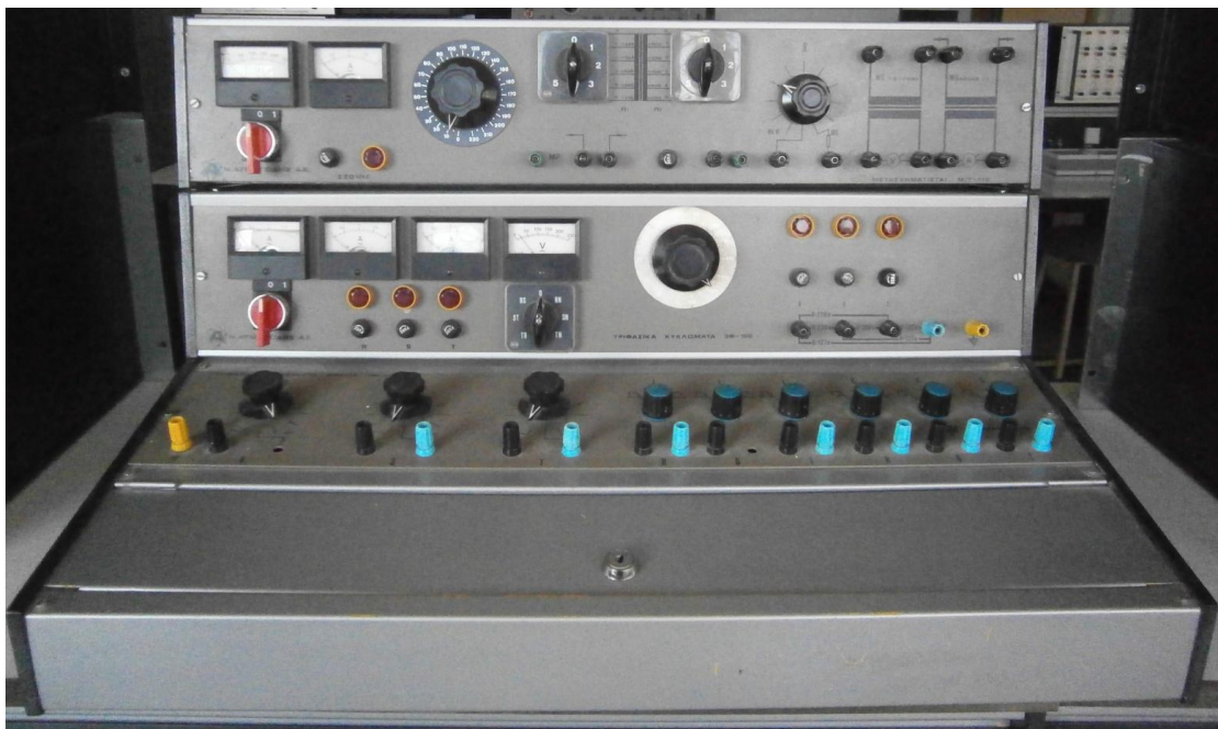
Εικόνα 3: Αυτόνομη μονάδα παροχής AC και DC τάσης με μεταβλητά φορτία.
