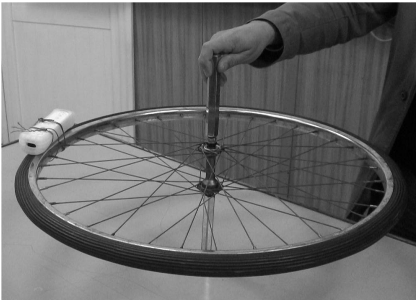
Εικόνα 5. Το wiimote δεμένο σε ρόδα ποδηλάτου που περιστρέφεται σε επίπεδο παράλληλο προς το έδαφος
