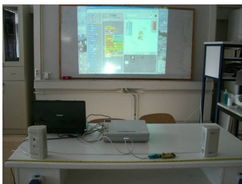
Σχήμα 1. Η διάταξη μέτρησης της ταχύτητας του ήχου στον αέρα
