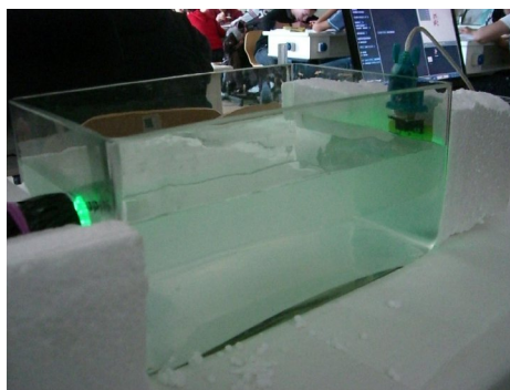
Σχήμα 4. Η διάταξη μέτρησης της έντασης του φωτός που διέρχεται από οπτικά μέσα
