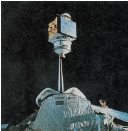
ΣΧΗΜΑ 3.3. Ο διαστημικός σταθμός έχει χρησιμοποιηθεί, για να τεθούν εμπορικοί δορυφόροι επικοινωνίας, όπως αυτός που εμφανίζεται εδώ, σε τροχιά. Έχει χρησιμοποιηθεί επίσης για να θέτει σε λειτουργία στρατιωτικούς δορυφόρους.
