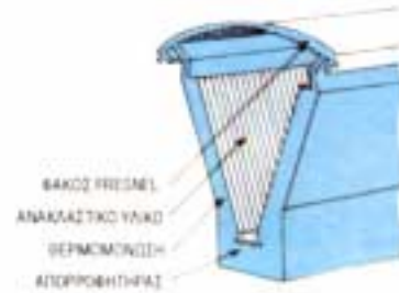
Σχ. 10-42. Δύο τύποι συλλέκτη παραβολικών αυλακίων. Έπάνω: Με αβαθές αυλάκι. Κάτω: Συλλέκτης με βαθύ αυλάκι. Σημειώστε ότι ο απορροφητήρας είναι στο δάπεδο του αυλακιού (ΗΛΙΟΣ).
