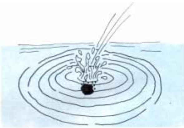
Σχ. 10-8. Τα ηλεκτρομαγνητικά κύματα ενέργειας διαδίδονται από την πηγή προς τα έξω, όπως γίνεται με τα υδατοκύματα (ρουτίζσεις), που κινούνται απομακρυνόμενα από το σημείο, όπου έπεσε μια πέτρα.
