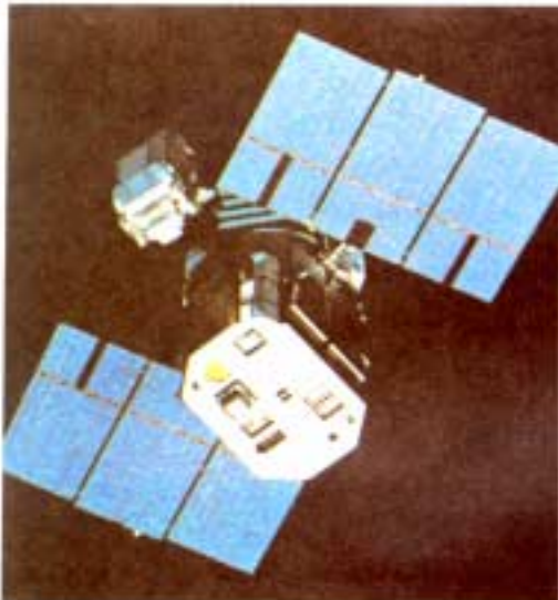
Σχ. 10-39 Ηλιακές συστοιχίες (συστήματα ηλεκτρικής ισχύος για τη λειτουργία των ηλεκτρονικών διατάξεων πειρατικών δορυφόρων) (NASA)
