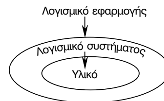
Σχήμα 5-1. Το λογισμικό εφαρμογής μπορεί να εκμεταλλευτεί το υλικό μόνο μέσω του λογισμικού συστήματος.
