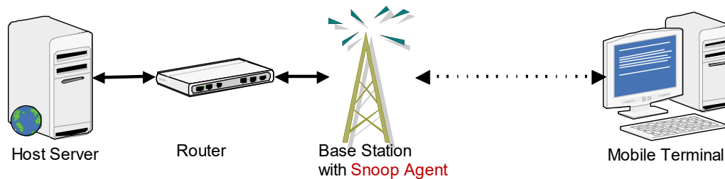
Εικόνα 3-2. Τρόπος λειτουργίας του Snoop.
