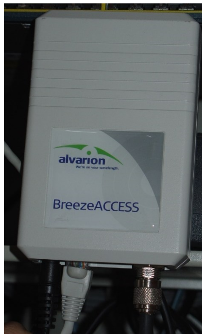
Εικόνα 5-7. Εσωτερική συσκευή ασύρματης σύνδεσης BreezeAccess II της Alvarion.
