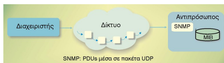
Εικόνα 4-8. Μεταφορά μηνυμάτων στο SNMP.
