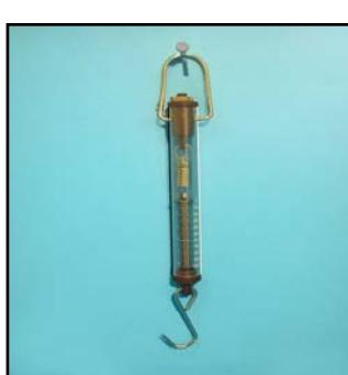
Αν δεν έχεις στη διάθεσή σου ένα απλό δυναμόμετρο, όπως αυτό στη διπλανή εικόνα, κατασκεύασε ένα αυτοσχέδιο δυναμόμετρο χρησιμοποιώντας ελατήριο ή λάστιχο.
