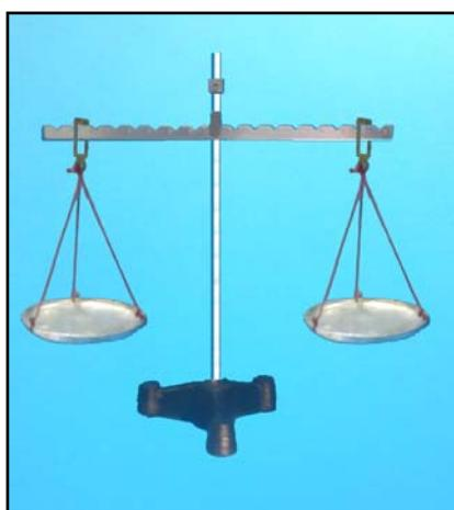
Αν δεν έχεις στη διάθεσή σου έναν απλό ζυγό σύγκρισης (με δύο βραχίονες και δύο δίσκους, όπως αυτόν στη διπλανή εικόνα), κάνε μια ιδιοκατασκευή, μετασχηματίζοντας λίγο μια ξύλινη κρεμάστρα.
