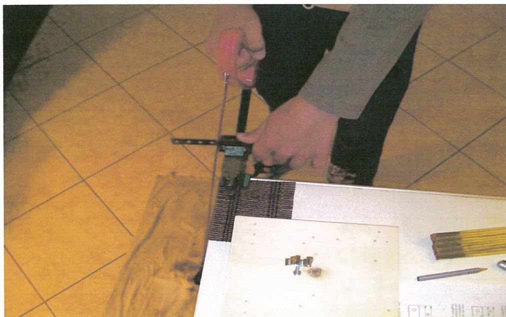
ΕΙΚΟΝΑ 2. ΚΟΨΙΜΟ ΤΩΝ ΜΕΤΑΛΛΙΚΩΝ ΛΩΡΙΔΩΝ ΜΕ ΣΙΔΕΡΟΠΡΙΝΟ ΚΑΙ ΜΕ ΤΗ ΒΟΗΘΕΙΑ ΜΕΓΤΕΝΗΣ
