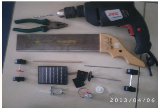
Εικ.1 Εδώ απεικονίζονται όλα τα υλικά και τα εργαλεία που χρησιμοποίησα στην κατασκευή.
