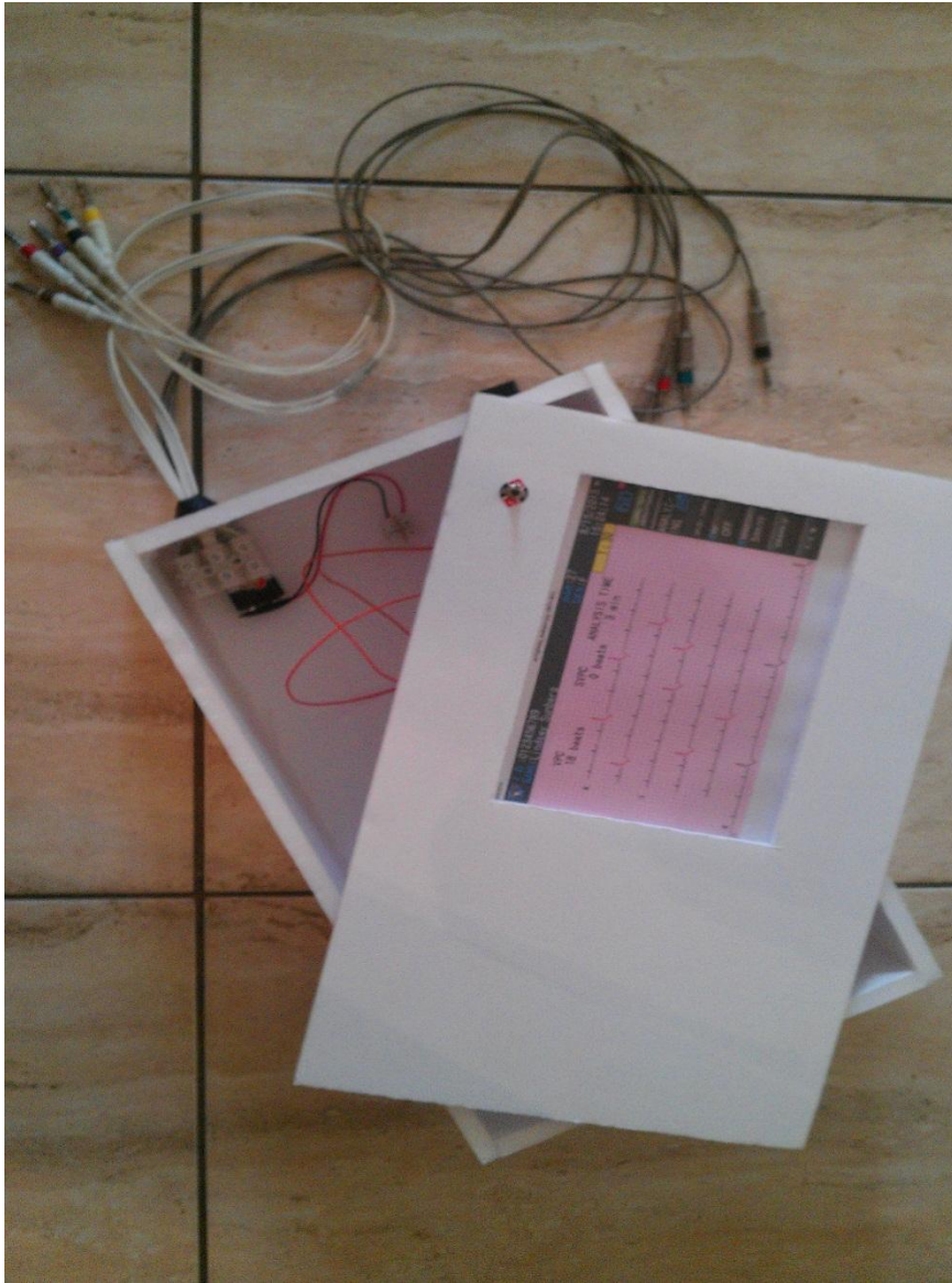
Εικόνα 7: Μετά κάνουμε μια εγκοπή στο κάτω μέρος της αριστερής πλάγιας όψης για να περάσουμε τα ηλεκτρόδια.
