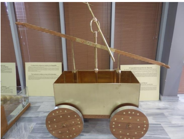
Εικόνα 25 : Η πυροσβεστική αντλία του Ήρωνα
