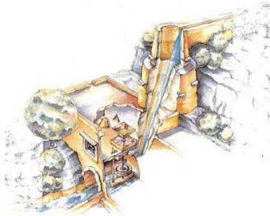
Εικ.24 : Λειτουργία νερόμυλου
