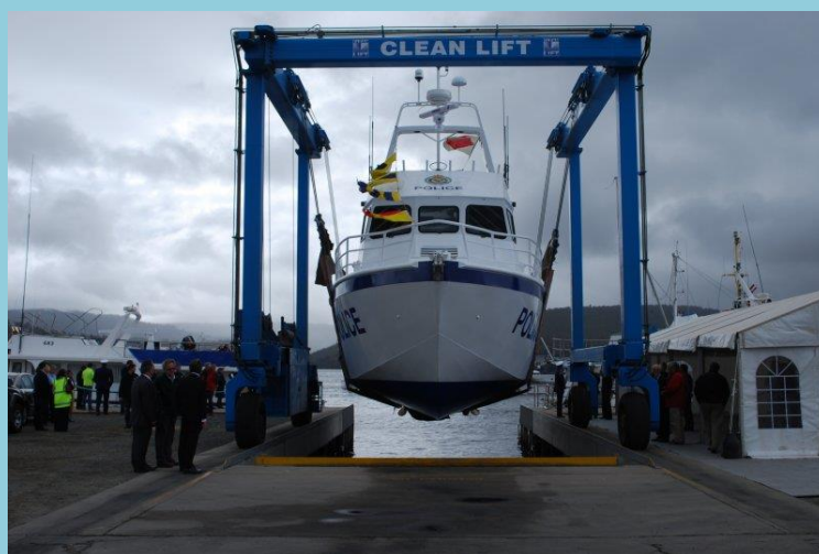
Εικόνα 4: Γερανός ανέλκυσης σκαφών
