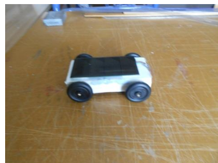
Εικόνα 17 : Τοποθέτηση φωτοβολταϊκού στο πάνω μέρος του πλαισίου, ολοκληρώνοντας το δοκίμιο
