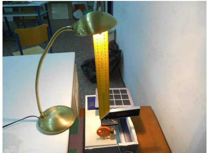
Εικόνα 24: Αλλαγή θέσης της απόστασης του φωτοβολταϊκού από το φωτιστικό σε 35 εκ., για καλύτερη διακύμανση τιμών , στις διάφορες θέσεις της γωνίας πρόσπτωσης των ακτίνων του φωτός
