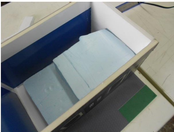
Εικόνα 16: Τοποθέτηση dow για στήριξη της διάταξης του φωτοβολταϊκού
