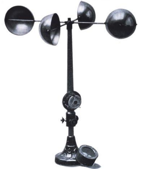
Εικόνα 4 : Ένα ημισφαιρικό κύπελλο ανεμόμετρο του τύπου εφευρέθηκε το 1846 από τον John Thomas Romney Robinson
