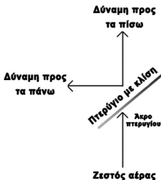
Εικόνα 8 : Διάγραμμα δυνάμεων που ασκούνται στο καρουσέλ-κερί , όταν λειτουργεί.
