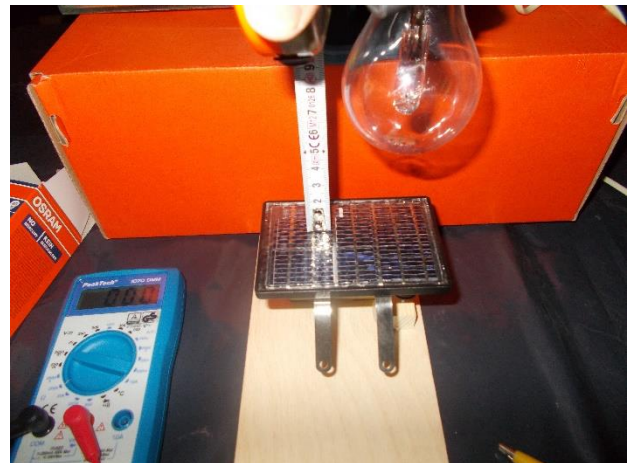
Εικόνα 9 : Μέτρηση απόστασης ηλιακού κυττάρου και λάμπας ( 5 εκ.)
