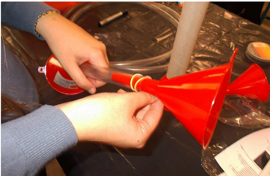
Εικόνα 8 : Στήριξη πλαστικών χωνιών με πλαστικό σωλήνα, αρχικά μ' ένα λαστιχάκι.
