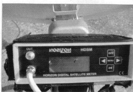
12 Συντονίζουμε το πεδίομετρο ή το δέκτη σε μία συχνότητα του Badr 26E και μεταβάλλουμε ελαφρώς την ανύψωση, μέχρι να λάβουμε το μέγιστο σήμα.
