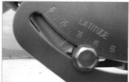
7 Στη μία πλευρά υπάρχει η ένδειξη "Latitude", που ρυθμίζεται σύμφωνα με το γεωγραφικό πλάτος της περιοχής μας.
