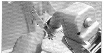
9 Τοποθετούμε το κάτοπτρο πάνω στο μοτέρ και σφίγγουμε τις βίδες που το συγκρατούν.
