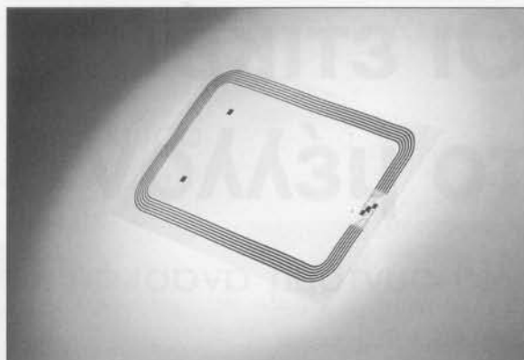
Σχήμα 1. Μία ετικέτα RFID με κεραία και ολοκληρωμένο.
