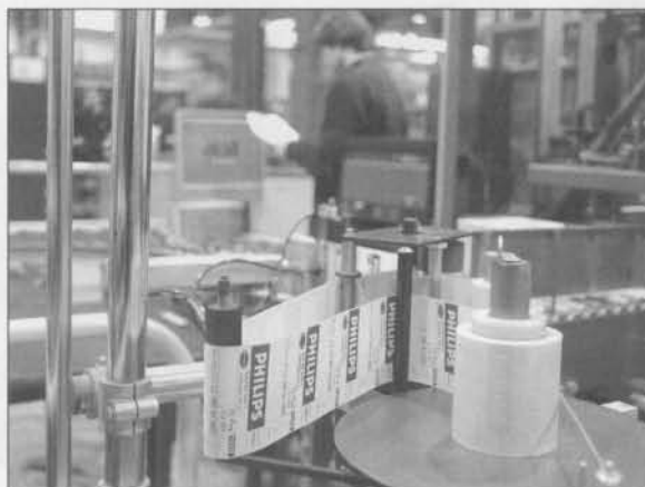
Σχήμα 2. Ετικέτες σε ρολό. Το εσωτερικό στρώμα αποτελείται από ένα ολοκληρωμένο, το πηνίο της κεραίας και ένα υποστρώμα (από χαρτί ή πλαστικό).
