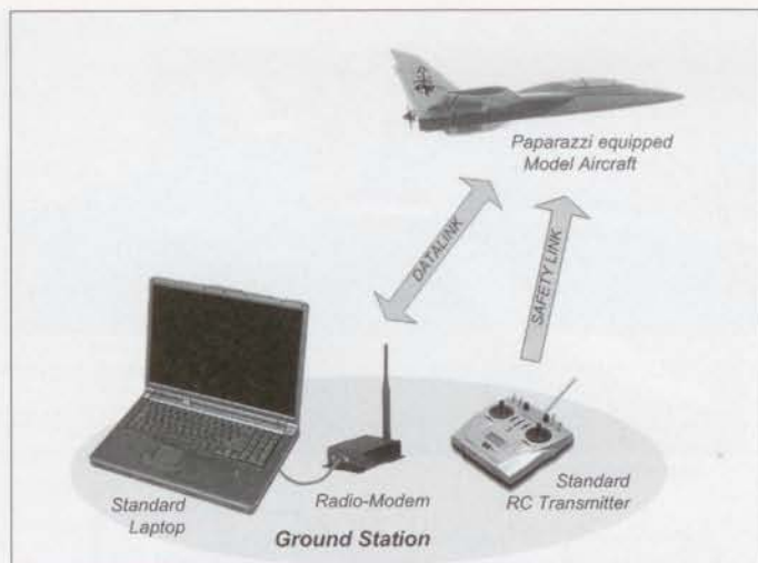
Σχ. 1. Ο σταθμός εδάφους ενός UAV ανοικτού κώδικα. Αποτελείται από ένα φορητό υπολογιστή, ένα ασύρματο μόντεμ και ένα συνηθισμένο χειριστήριο τηλεκατευθυνόμενων μοντέλων.
