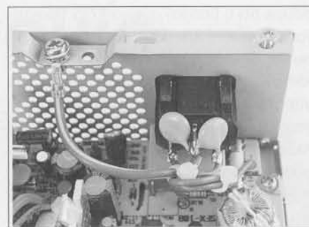
Σχήμα 9. Η σύνδεση γης σε ένα τροφοδοτικό για υπολογιστή.
