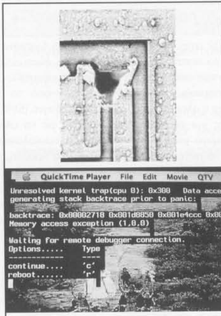
Σχήμα 7. Μία καμμένη δίοδος σε ένα ολοκληρωμένο (επάνω) και ένας "κολλημένος" υπολογιστής (κάτω). Οφείλονται σε κάποιο εσωτερικό πρόβλημα, ή σε εξωτερικές επιδράσεις;
