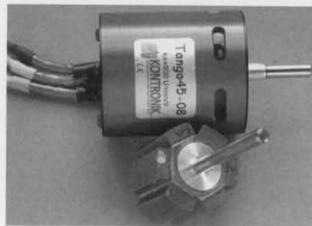
Σχήμα 10. Ψευδόμορφος άνευ σιδήρου κινητήρας τύπου 'Tango' με εξαπολικό ρότορα.
