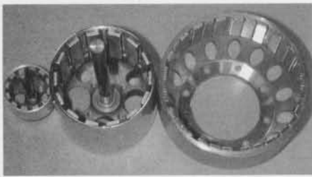
Σχήμα 12. Η απόσταση μεταξύ των μαγνητών σε μια μηχανή πολλαπλών πόλων (στη προκείμενη περίπτωση με εξωτερικό ρότορα) δεν θα πρέπει να είναι και τόσο μικρή. Στα δεξιά βλέπουμε έναν ρότορα δέκα πόλων όπου ένας πόλος σχηματίζεται από κάθε μια ομάδα τριών ρυθμιζόμενων μαγνητικών λωρίδων.
