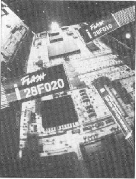
Σχ. 5. Εφαρμογή με Flash-EPROM: Μια κάρτα ελέγχου PostScript (της Pyramid) για επιτάχυνση της λειτουργίας εκτυπωτών HP-Laserjet. Η κάρτα περιλαμβάνει μεταξύ άλλων και μια Flash-EPROM 2MB (28F020 της Intel), χάρη στην οποία ο χρήστης έχει τη δυνατότητα να φορτώσει κάποια εξελιγμένη γλώσσα PostScript εκσυγχρονίζοντας έτσι την κάρτα του χωρίς να την αλλάξει.
