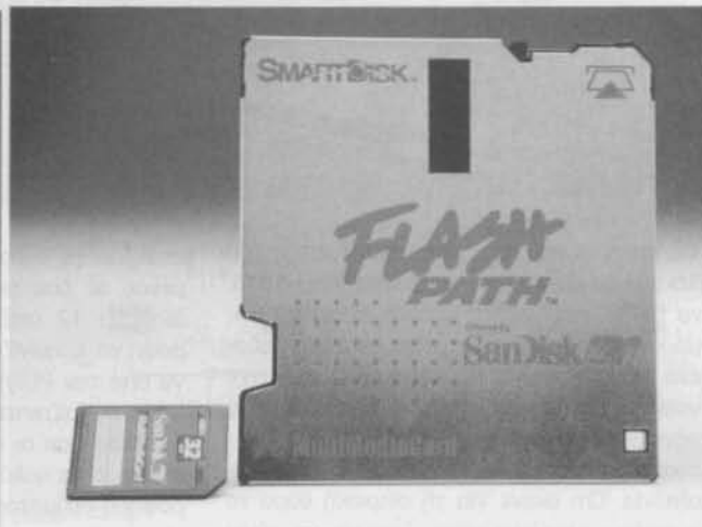
Σχήμα 8. Ο συγκεκριμένος προσαρμοστής διακέτας έχει σχεδιαστεί για μονάδες MMC.
