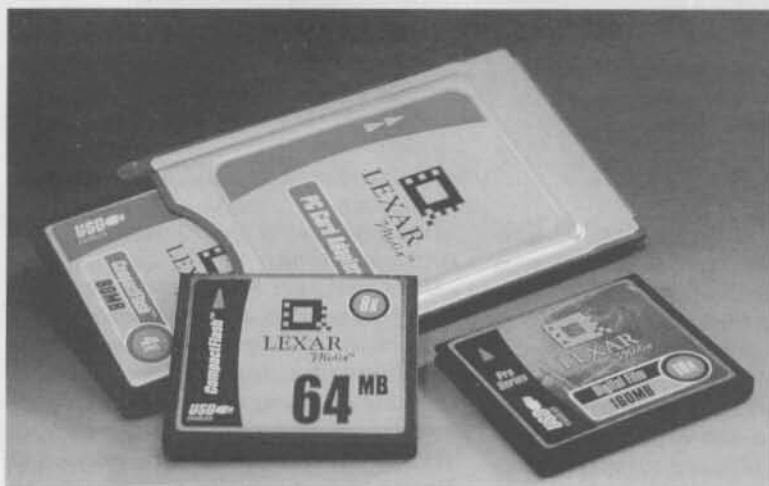
Σχήμα 7. Προσαρμοστής PCMCIA της Lexar για τις μονάδες CF και CF+.
