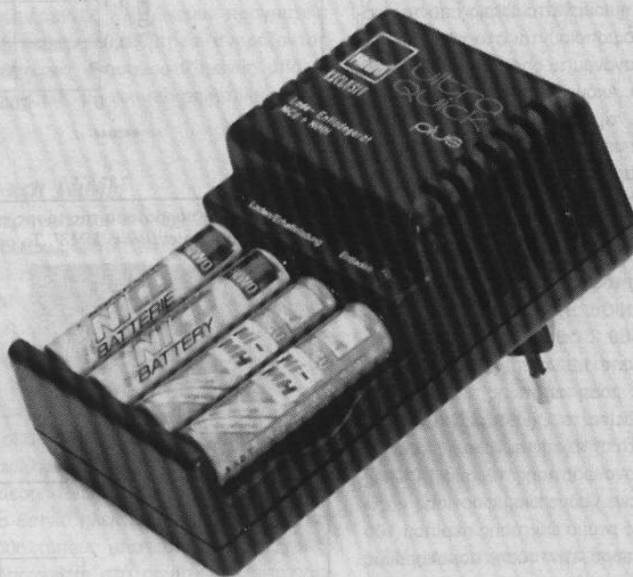
Σχ. 7. Ο εικονιζόμενος φορτιστής της Friwo είναι ένα παράδειγμα έξυπνου φορτιστή 1 ώρας, πολλαπλών καθκόντων. Είναι συμβατός με μπαταρίες NiCd και NiMH, εκτελεί ταχεία φόρτιση, αυτόματη εκφόρτιση, έλεγχο αρνητικού δέλτα-U, και αυτόματη διακοπή μέσω χρονοδιακόπτη.
