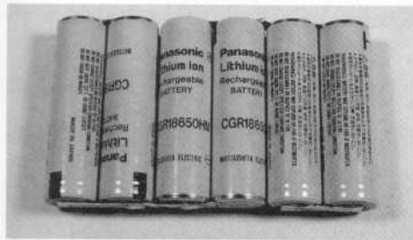
Σχήμα 5. Μπαταρία ιόντων Λιθίου σε συσκευασία 3S2P για φορητούς υπολογιστές (τάση ακροδεκτών 10,8 V)
