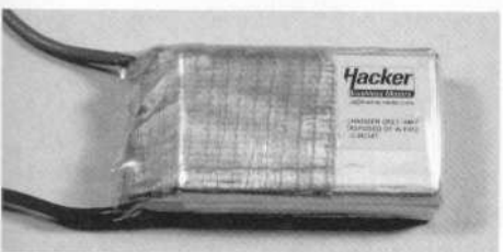
Σχήμα 8. Ένα μεγάλο κομμάτι ταινίας λειτουργεί σαν διάταξη συγκράτησης των καλωδίων σύνδεσης.
