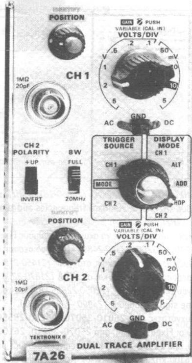
Φωτ. 1: Βαθμίδα ενισχυτή με 2 κανάλια. Διακρίνονται τα ρυθμιστικά (Y) Position, οι επιλογείς V/div με ενσωματωμένα τα χειριστήρια αδιαβάθμητης ρύθμισης, οι εισόδου, οι επιλογέας mode λειτουργίας καναλιών κλπ.
