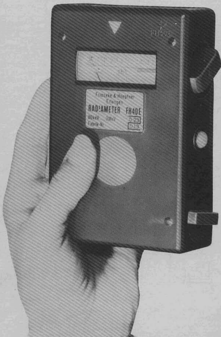
Φωτογραφία 2. Ένας βιομηχανικός μετρητής geiger - müller για τη μέτρηση της ακτινοβολίας.
