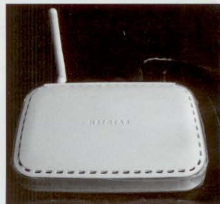
Σχήμα 2. Ένα τυπικό σημείο πρόσβασης: σε πολλές περιπτώσεις αυτά εξυπηρετούν στο να μειώσουμε το μήκος του καλωδίου της κεραίας.
