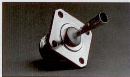
Σχήμα 8. Σύνδεσμος τύπου N, στο οποίο έχει κολληθεί το στέλεχος εκπομπής κατασκευασμένο από φύλλο χαλκού.
