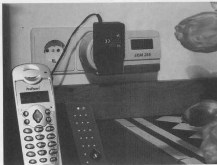
Σχήμα 1. Η μέτρηση της καταναλισκόμενης ηλεκτρικής ισχύος είναι αρκετά απλή - τοποθετήστε την συσκευή μέτρησης μεταξύ της παροχής και της πρίζας προς τον καταναλωτή. Θα εκπλαγείτε από τα αποτελέσματα των μετρήσεων!
