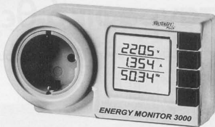
Σχήμα 3. Αποψη μιας διάταξης μέτρησης ηλεκτρικών καταναλώσεων (Conrad Electronics).
