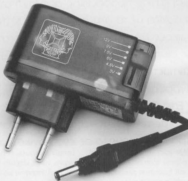
Σχήμα 2. Ένα τροφοδοτικό μεταγωγής πρίζας αποτελεί μια πιο συμπαγή και αρκετά φιλική από άποψη κατανάλωσης λύση σε σχέση με τις αντίστοιχες κλασικές διατάξεις.
