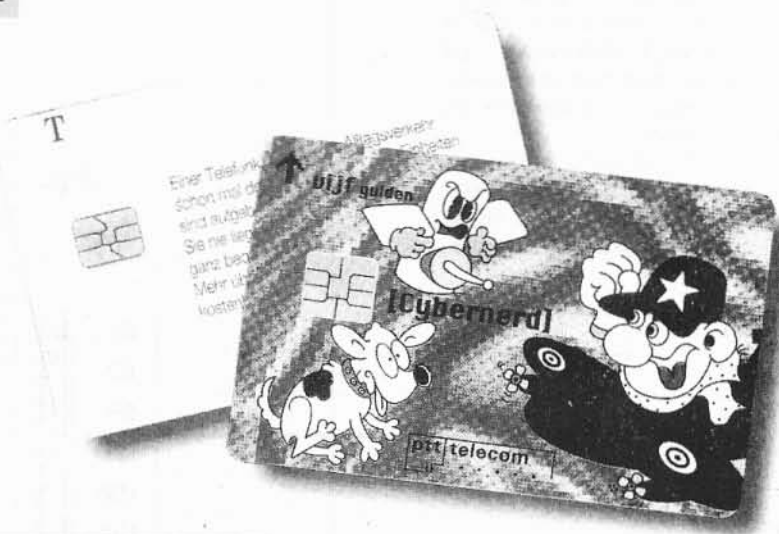
Σχήμα 2. Σε αυτές τις τηλεκάρτες, το ολοκληρωμένο είναι στη θέση ISO.
