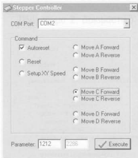
Σχήμα 4. Το πρόγραμμα αποστολής 'εντολών' προς τον θηματικό κινητήρα, από την πλευρά του υπολογιστή.
