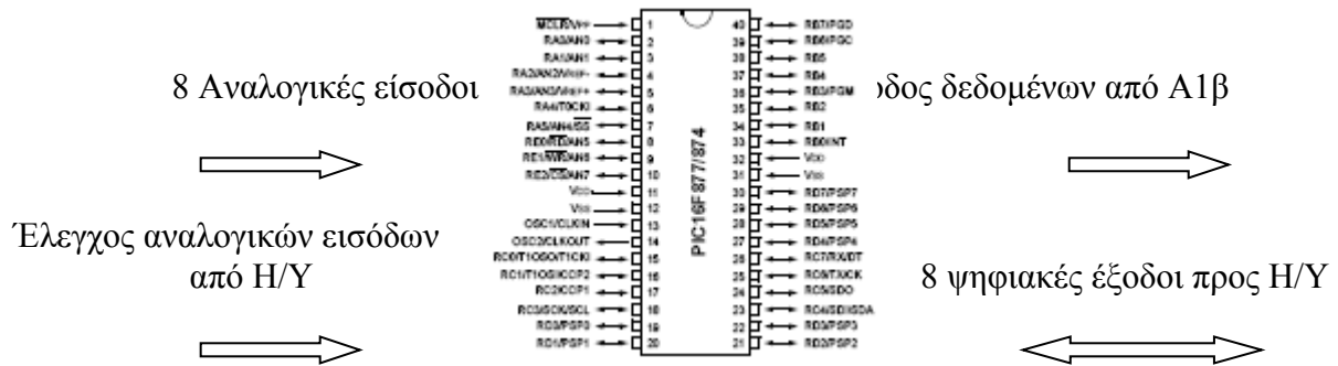
Σχήμα Π1.1 Κύκλωμα για είσοδο αναλογικών και έξοδο ψηφιακών δεδομένων από και προς την παράλληλη θύρα του Η/Υ.
