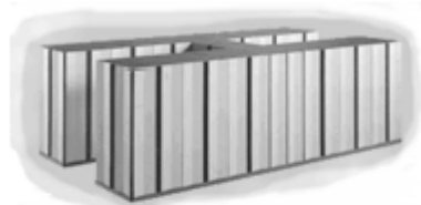
HITACHI SR2201 Κορυφαίο μοντέλο, στην κατηγορία των υπερυπολογιστών: Παράλληλη επεξεργασία, τεχνολογία RISC, δυνατότητα για περισσότερες από 600 δισεκατομμύρια πράξεις κινητής υποδιαστολής. Μπορεί να έχει περισσότερους από 32 και μέχρι 2048 επεξεργαστές
