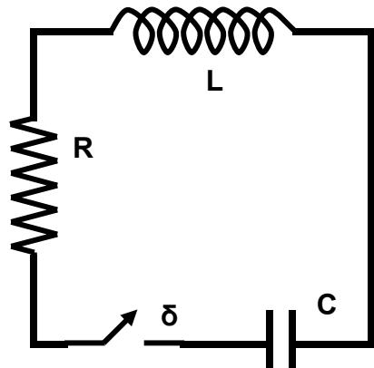
Τη χρονική στιγμή  $t_0 = 0$  κλείνουμε το διακόπτη  $\delta$ . Κάποια μεταγενέστερη χρονική στιγμή  $t_1$ , το φορτίο του πυκνωτή είναι μηδέν και η ένταση του ρεύματος που διαρρέει το πηνίο είναι 6 A. Από τη στιγμή  $t_0$  έως τη στιγμή  $t_1$  η συνολική ενέργεια της ηλεκτρικής ταλάντωσης μειώθηκε κατά:
