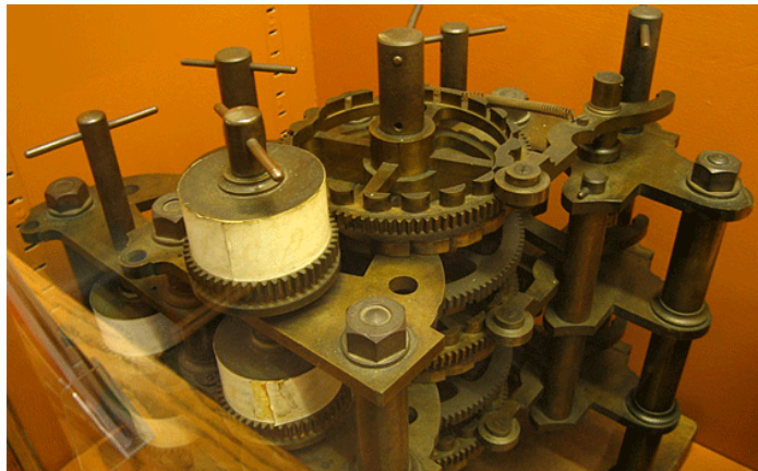
Εικόνα 3: Μικρό τμήμα της αναλυτικής μηχανής κατασκευασμένο από τον γιό του Babbage από τμήματα που βρέθηκαν στο εργαστήριό του
