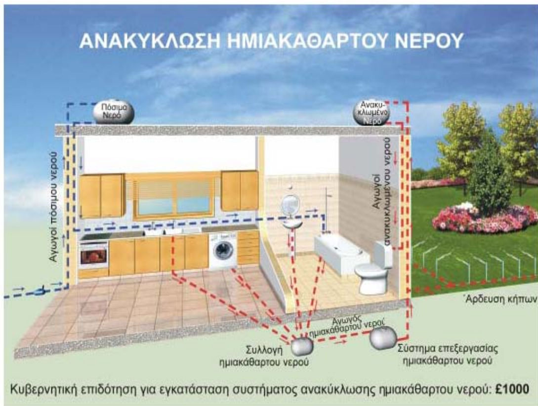
Εικ. 1: Σύστημα ανακύκλωσης ημιακάθαρτου νερού (grey water), επιδοτούμενο από την Κυπριακή κυβέρνηση με στόχο την μείωση της κατανάλωσης καθαρού πόσιμου νερού στην Κύπρο.
