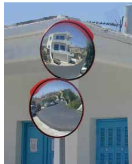
Εικόνα 7.15 Διεύρυνση του οπτικού πεδίου με τη χρήση κυρτού καθρέφτη.
