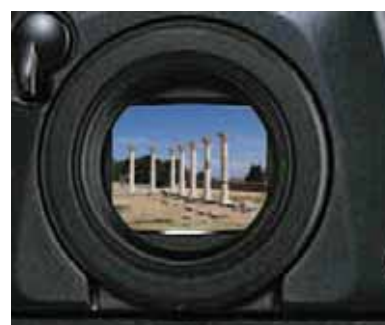
Εικόνα 9.16 Το σκόπευτρο μιας φωτογραφικής μηχανής.
