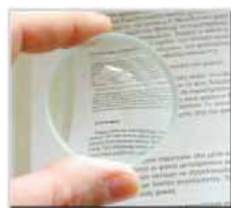
Εικόνα 9.14 Το μέγεθος του ειδώλου σ' έναν αποκλίνοντα φακό είναι μικρότερο του αντικείμενου.
