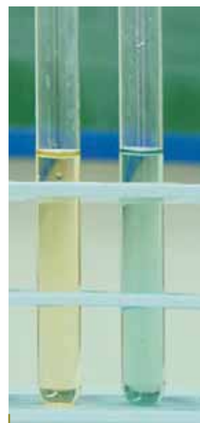
Το χρώμα του δείκτη μπλε της βρομοθυμόλης σε όξινο και ουδέτερο περιβάλλον αντίστοιχα
