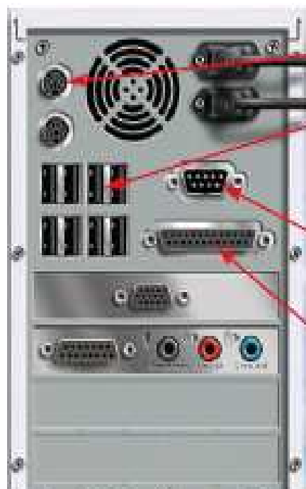
Εικόνα 2.6. Οι θύρες σύνδεσης του υπολογιστή
